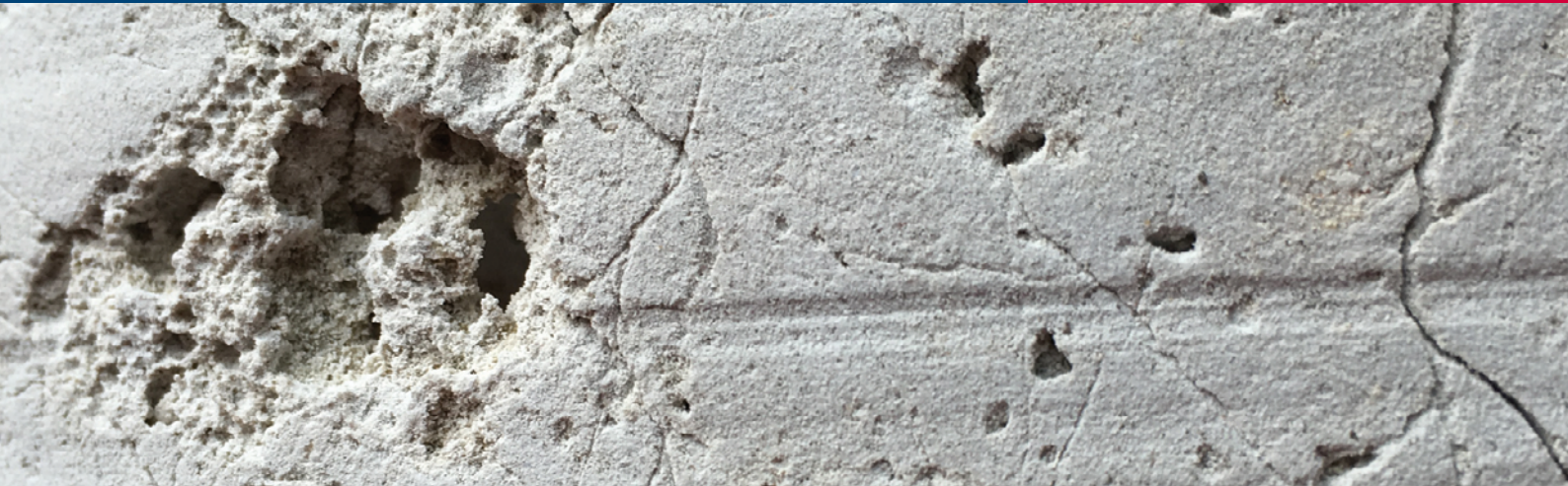
Carbonatgestein nach einer Säuerung
